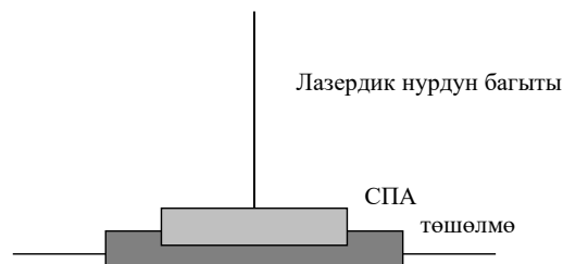
2-сүрөт. Лазердик иштетүү процессинде синтетикалык поликристаллдык алмазга багытталышы.
